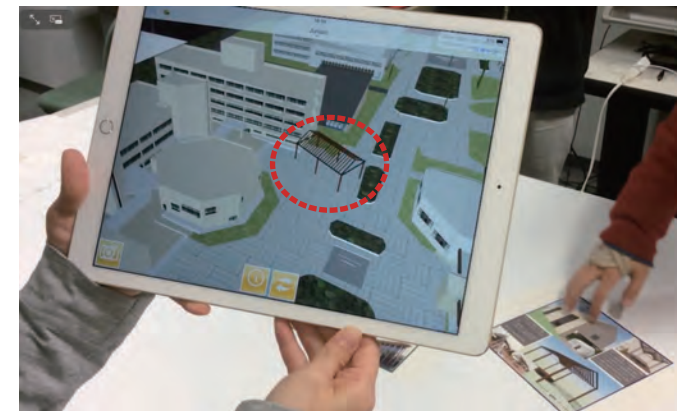
写真3 ARを利用した多人数参加型討論システムの操作の様子。机上のシートをタブレットで写すと配置したい「パーゴラ」（赤破線枠）が3次元モデルに表示される。タブレットを持つ参加者全員が独自の視点で仮想モデルを参照でき、かつマーカーとなるシートを動かすと仮想空間上のモデルも自由に位置を変更できる。
