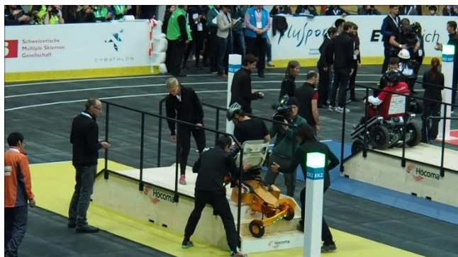
図 18. 階段を搭乗部は水平に維持したまま脚動作で上る PType WA
