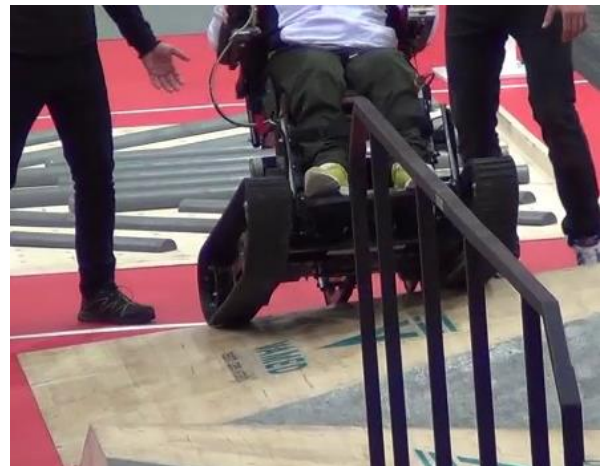
図 24. 香港(銀メダル)チームの左右斜面走行。ベルトが路面から相当浮いた状態で傾斜角度が変わるとドン！とパイロットに衝撃が。
