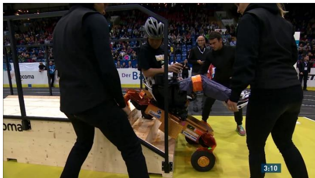
図 19. 階段を搭乗部は水平に維持したまま脚動作で下る PType WA (by ETH Zurich / SRF)
