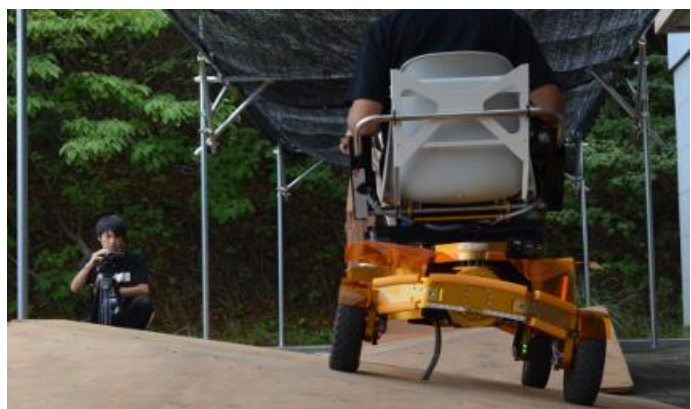
図 25. 単管パイプで自作した屋外走行練習場。天気にも左右される。
