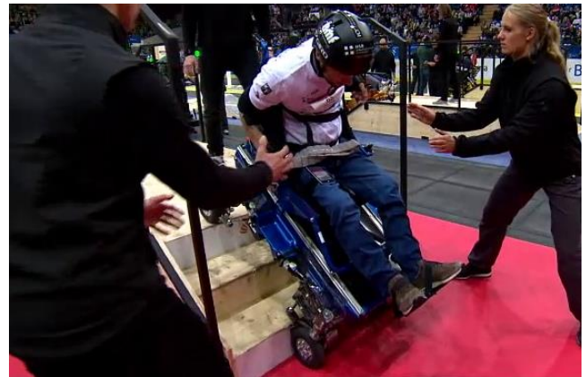
図 21. スイス(金メダル)チームは階段の上り(上)と下り(下, by ETH Zurich / SRF)でパイロットの姿勢は相当傾いていた。実はパイロットは、下りの際にはシートから落ちないように左腕全体をシート背面に回してしっかりと体を支えなければならぬようだ。
