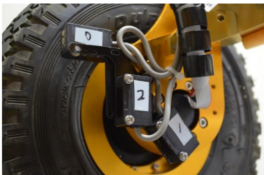
図 10. 車輪周囲の障害物や床を検出する光電センサ
