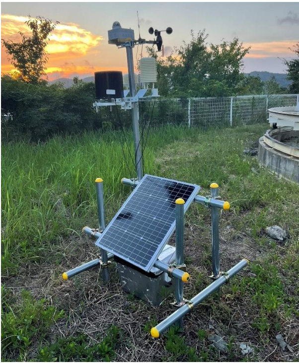
図 2 学内に設置された気象観測ステーション
