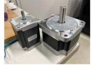
左: 昨年度使用したステッピングモータ 右: 本年度使用する高トルクステッピングモータ
