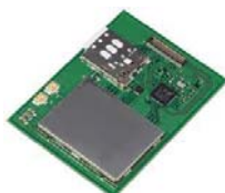
図3 無線通信モジュール
