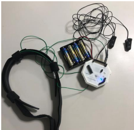
図 1 カチューシャ型の簡易脳波計
