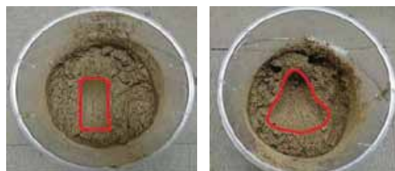
図-13 単輪実験時における操舵角による轍の違い
