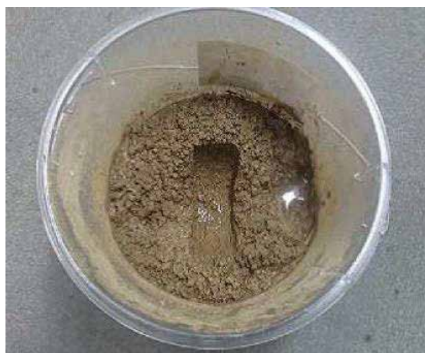
図-12 単輪実験時における轍の形成
