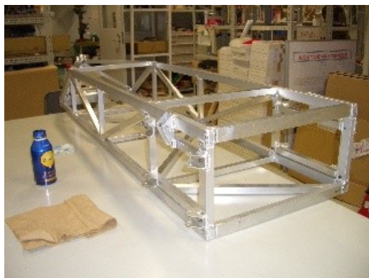
図7 本体フレーム溶接完了
