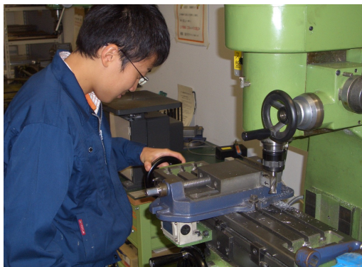
図6 本体フレーム補強パーツ製作
