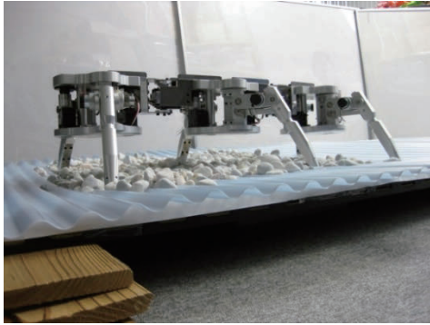
図-14 軟弱な足場対応ロボット試作機
