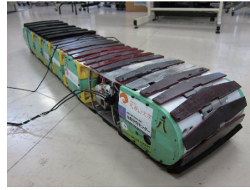
図-16 柔軟全周囲クローラ (FMT) システム
