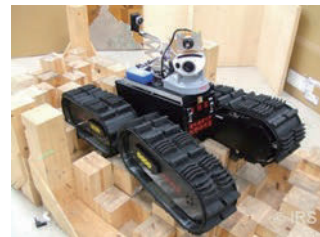
図-3 大大特プロジェクトで開発された瓦礫上システム例
