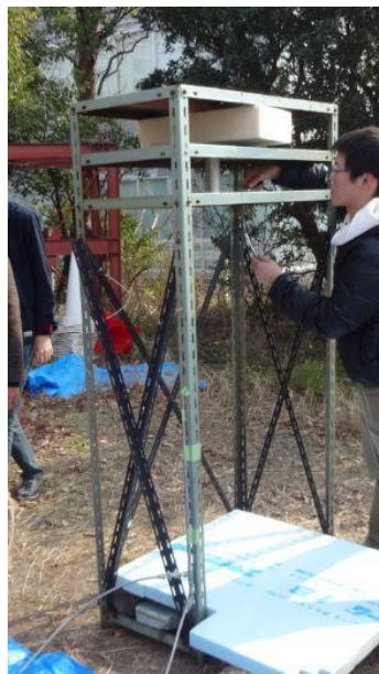
図1 WSPの縦型燃焼台
